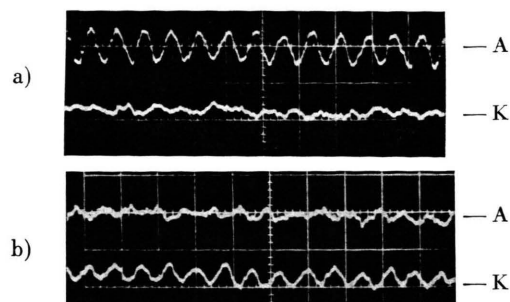
Abb. 14. Zur z -Abhängigkeit der Störungen. a) Einsetzen der Mode m=6 ; b) m=6 , unmittelbar vor dem Übergang zu m=7 . A = anodenseitiges Signal, K = kathodenseitiges Signal (Ablenkung: 1 \mu\text{s/cm} ).
